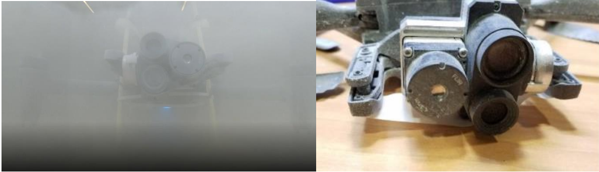
Fig. 7: IP5X test (sand)
